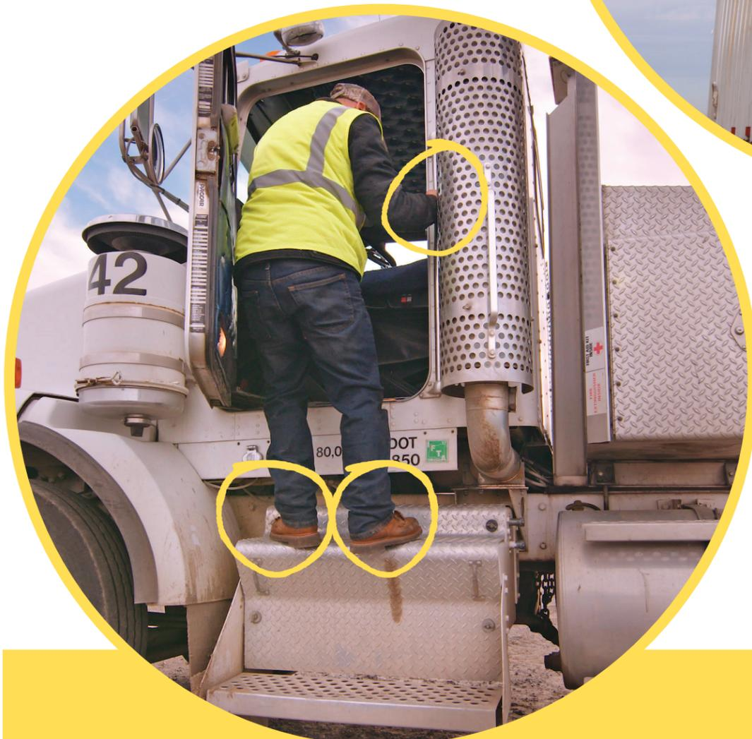
**3** Solo suelta los puntos de apoyo una vez que estés completamente dentro de la cabina o fuera del vehículo.
